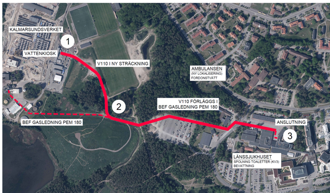
Figur 4: Ledningsdragning mellan Kalmarsundsverket och länssjukhuset
