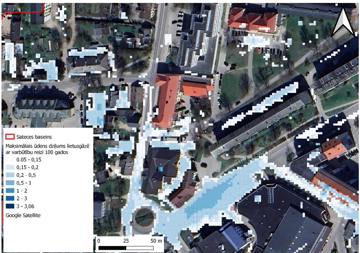
60. attēls. Maksimālais ūdens dziļums lietus plūdu gadījumā pie nokrišņu varbūtības reizi 100 gados (ap 12.30) Raudas un Meža ielas tuvumā.
