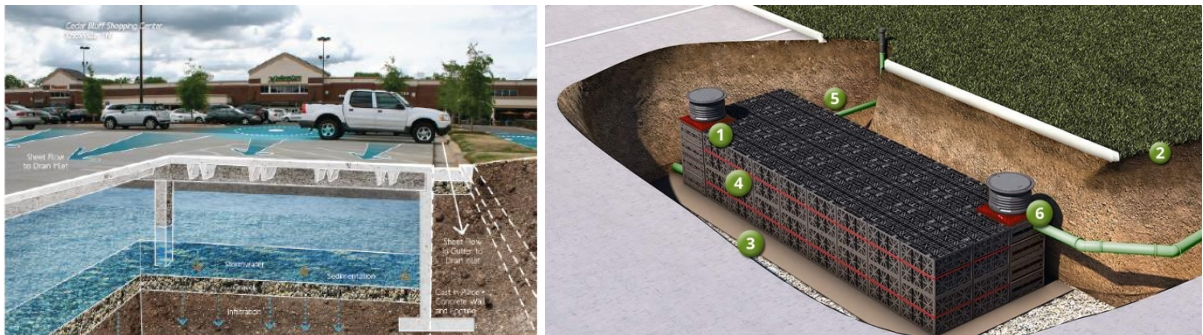
37. attēls. Ilgtspējīgas lietus ūdens apsaimniekošanas risinājumi: infiltrācijas sistēmas.
